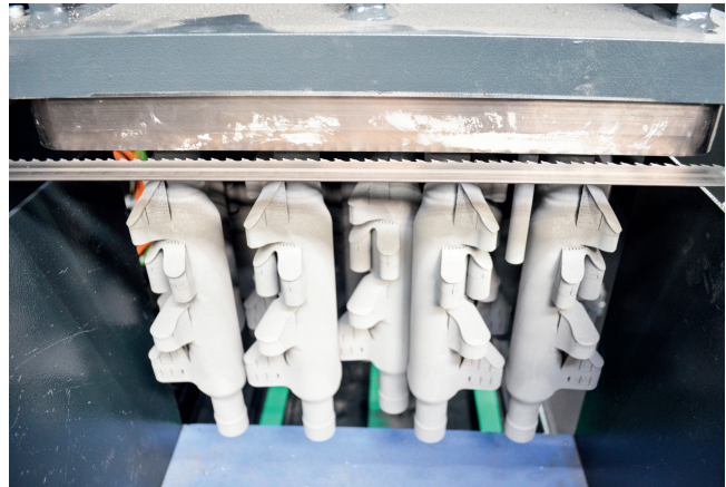
5 Die intelligente Steuerung ermöglicht es, die Teile jedes Mal exakt im entsprechenden Aufmaß abzutrennen. Das verringert den Nacharbeitsaufwand und spart Material (© Kasto)
