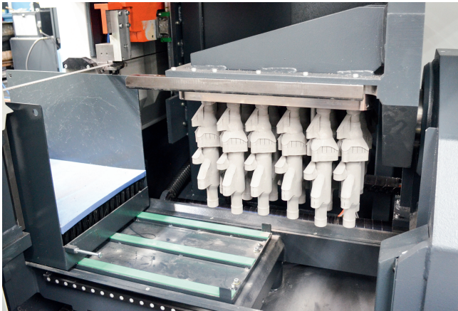
4 Gesägt wird bei der Kastowin amc kopfüber – das schont die teuren Bauteile, die sofort nach dem Abtrennen aus dem Gefahrenbereich der Schneide herausfallen und vor Beschädigungen geschützt sind (© Kasto)
